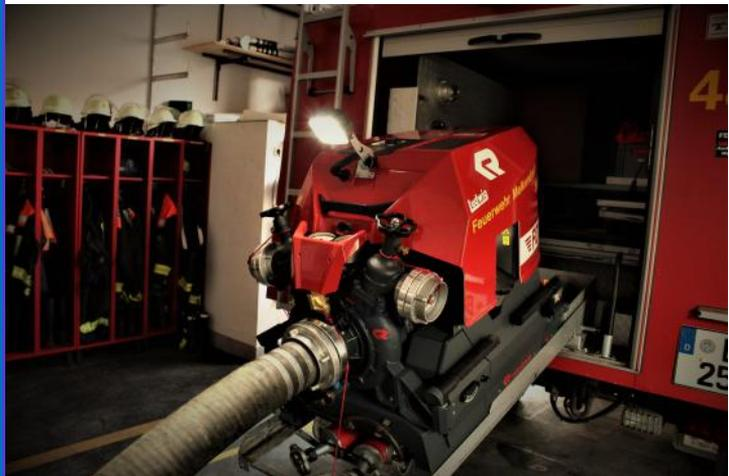
Im Vergleich zur alten TS 8/8 wiegt die Rosenbauer Fox4 32 kg weniger (166kg). Dies erleichtert den Einsatz mit der Pumpe. Die Wellenabdichtung erfolgt
